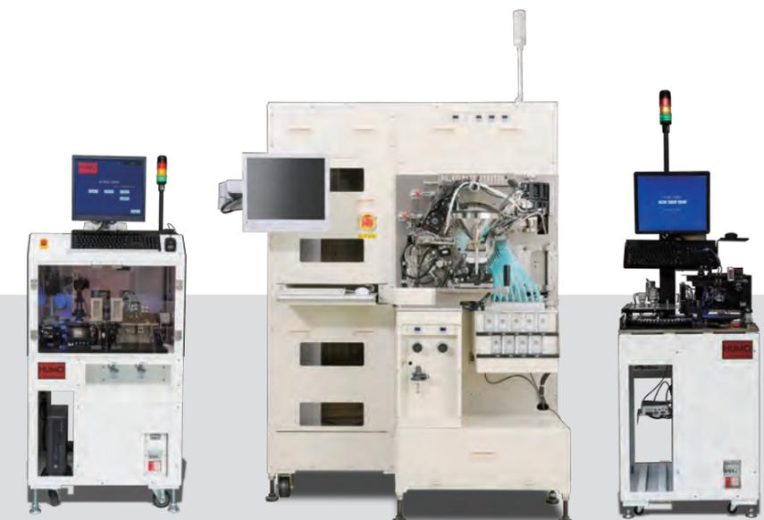
水晶ブランク外観検査装置
